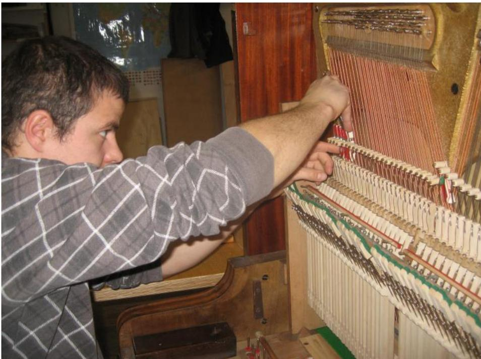
➤ Setzen der Dämpfung
